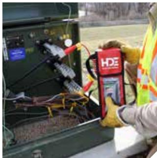
Indicación visual de circuitos abiertos, cortocircuitos, espiras en cortocircuito o bobinados
