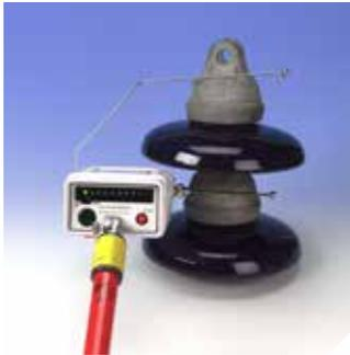
La escala de LED muestra la condición del aislamiento
